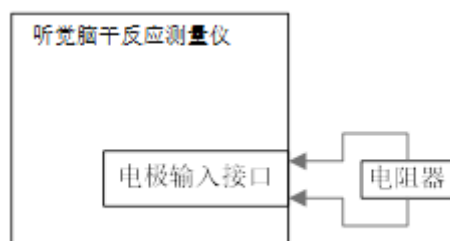
图3 电阻测量连接示意图
