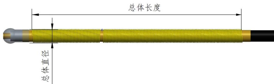
图1 加热元件长度与直径
