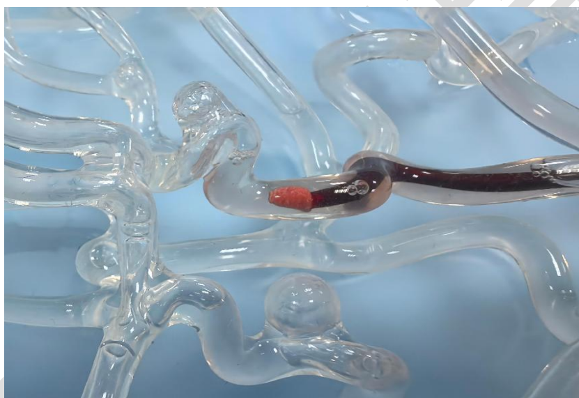
图 5 血栓抽吸能力验证实际操作示意
