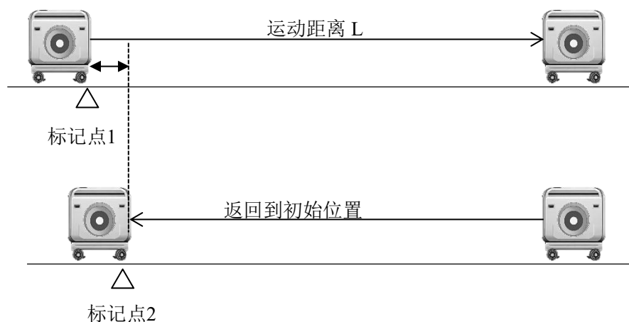
图2 长度重复定位精度的测量
