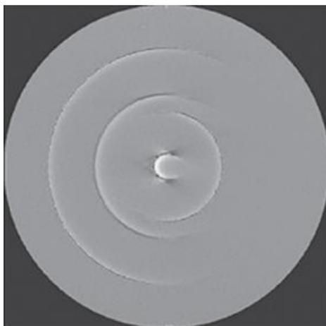
图F.1 轴向面显示体模的 PMMA 区域的环状伪影
